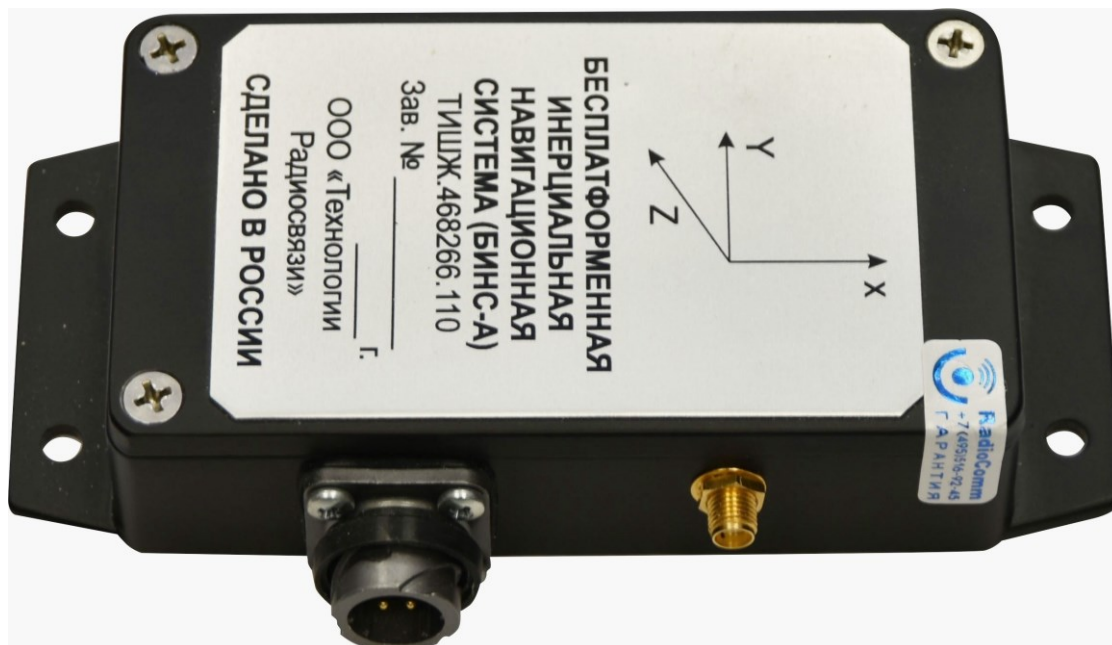
Рисунок 10 – Внешний вид БИНС-А ТИШЖ.468266.110
